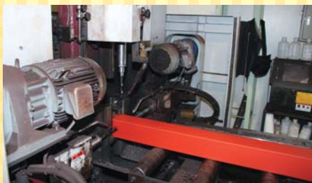
材料への穴あけ、切断、印字(番号)を行う東北に2台しかない機械で、作業の効率化を図っています。
