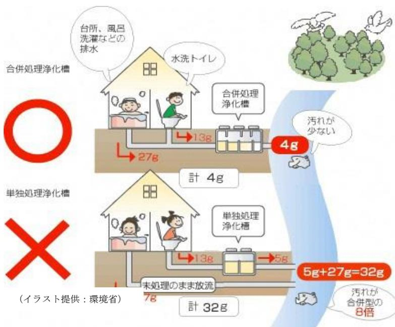
浄化槽には、トイレの汚水だけを処理する単独処理浄化槽と、トイレの汚水のほかに台所、風呂、洗濯等の生活雑排水も処理する合併処理浄化槽の2種類があり、単独処理浄化槽の家庭は合併処理浄化槽の約8倍汚れた水を流していることとなります。
