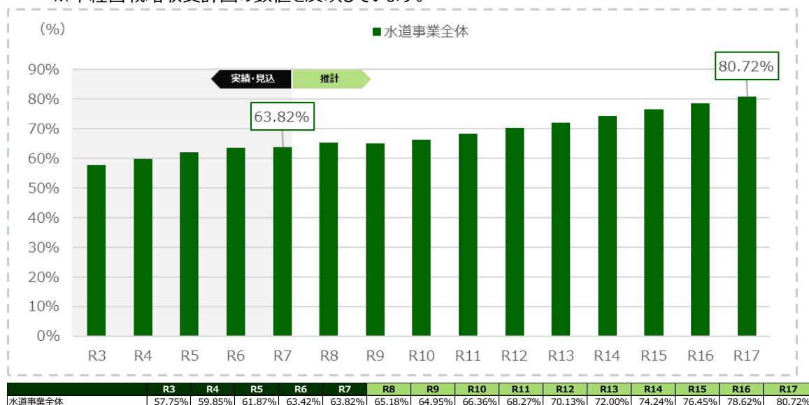
図 2-15 水道施設の老朽化の見通し
