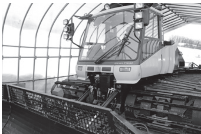
油圧ホースやキャタピラが劣化した圧雪車
